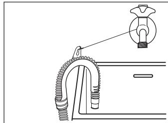
Dalam hal ini, pastikan hujung tidak disangkut apabila mesin dikosongkan. Ini boleh dilakukan dengan mengikatnya kepada paip air dengan tali atau menempatkannya pada dinding.
