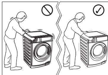
Jangan letakkan kadbad, kayu atau bahan yang sama di bawah mesin untuk meratakan lantai. Pasangkan mesin di atas lantai yang rata dan keras. Pastikan peredaran udara di sekeliling mesin tidak di ganggu oleh permaidani, dan sebagainya.
