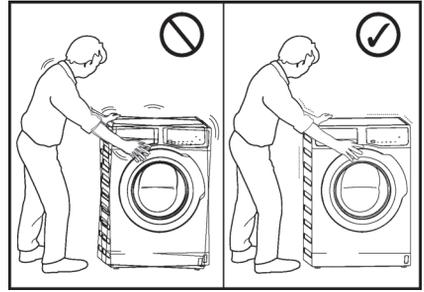
Jangan sekali-kali menempatkan kardus, kayu atau semacamnya di bawah mesin untuk mengkompensasi ketidakrataan di lantai. Pasang mesin pada lantai yang datar dan keras. Pastikan sirkulasi udara di sekitar mesin tidak terhalang oleh karpet, permadani, dll.
