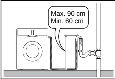
Untuk fungsi mesin yang benar, selang pembuangan harus tetap terkait ke bagian penopang yang benar yang ada di bagian atas pada sisi belakang alat.
