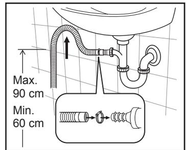
Dorong selang pembuangan ke keran dan kencangkan dengan klip, pastikan loop terbentuk di selang pembuangan untuk mencegah limbah dari bak cuci memasuki alat.
