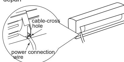
3. Lepaskan klip kawat; sambungkan kabel sambungan daya ke terminal kabel sesuai dengan warnanya; kencangkan sekrup dan kemudian perbaiki kabel sambungan listrik dengan klip kawat.
