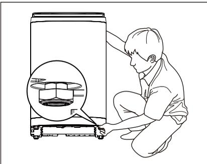
Jangan sekali-kali menempatkan karton, kayu, atau material sejenis di bawah mesin cuci untuk mengatasi ketidakdataran lantai.
