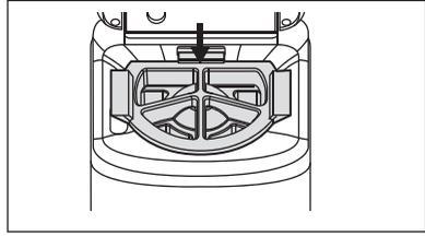
**! Penting :** Busa polistirena atas harus dilepaskan BELAKANG untuk melindungi *washing tube* dari terbentur badan mesin cuci saat mesin dimiringkan.
