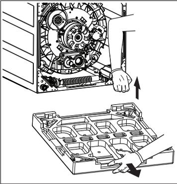
5. Pasang tutup bawah pada lubang di bawah mesin cuci (seperti ditunjukkan gambar).
