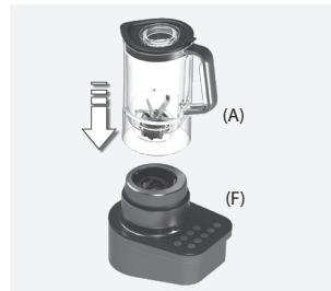
2. 将搅拌杯(A)的把柄朝前安装到底座(F)上 (搅拌杯只可由此方向固定)。将配料放入搅拌杯。(请勿超出搅拌杯上标注的最大容量。)
