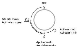
Untuk menutup aliran gas, putar kenop ke kanan hingga terasa jelas bunyi klik keran.
