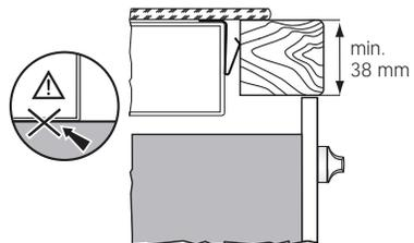
**Peringatan!** Temperatur alas kompor bisa melampaui 95°C, akses ke bawah kompor harus dilindungi menggunakan plat pelindung tahan api pada saat instalasi.
